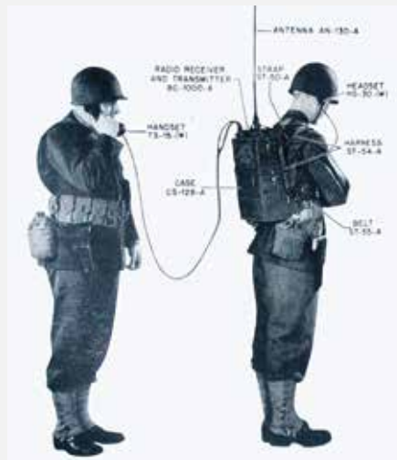
SCR-300 mieściła się w plecaku i umożliwiały ręczne ustawienie częstotliwości FM. W porównaniu z konkurencyjnymi urządzeniami, które były tak duże, że transportowano je przy użyciu czołgów, wynalazek Polaka był wręcz niewiarygodnie lekki. FOT. WIKIPEDIA
